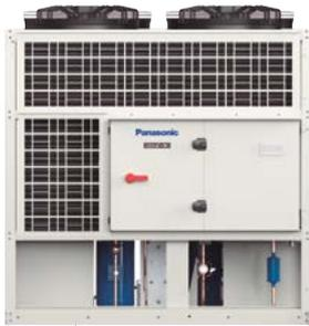
Gama de potentes enfriadoras bomba de calor aire-agua con 4 compresores en scroll. La temperatura máxima de salida de agua en modo calor es de hasta 50 °C <sup>1)</sup>. El diseño optimizado para limitar el desescarche asegura el suministro continuo de agua caliente incluso en bajas condiciones ambientales.
